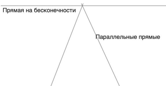
Рис. 3. Графическое изображение пересечения параллельных прямых на бесконечно удаленной прямой
